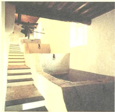
Vasche in muratura per il processo di separazione dell'olio
